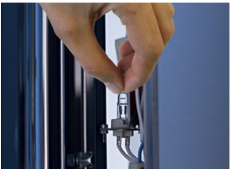
LAS LÁMPARAS ALÓGENAS SON FÁCILMENTE SUSTITUIBLES
